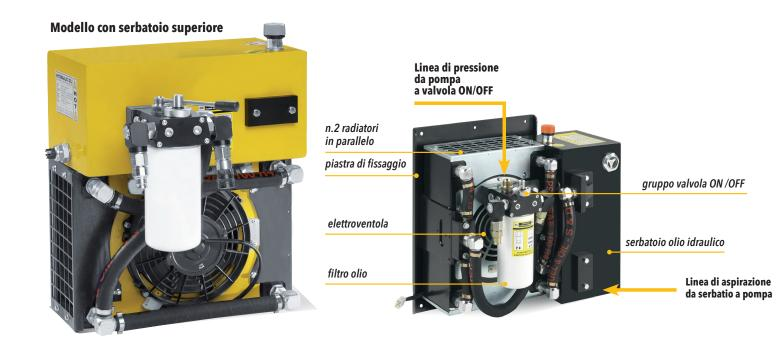
**HYDROBOX** è un compatto accessorio installabile su furgoni e camion, può essere montato su tutti i mezzi dotati di una pompa idraulica o che abbiano la possibilità di poterla installare, HYDROBOX trasforma questi veicoli in potenti ed economici azionatori di utensili idraulici e di attrezzature oleodinamiche varie come verricelli, generatori di corrente idraulici, gru, compressori, ecc.
